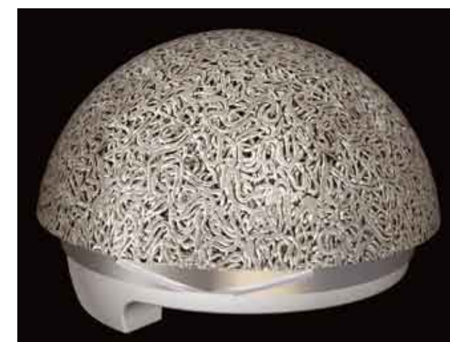
El liner se sujeta al shell mediante un sistema de clips de presión. Los extremos de tres pares de clips del borde del Shell se introducen en una ranura del liner. Los clips tienen una interferencia radial con la base de la ranura del liner que permite una firme sujeción.
