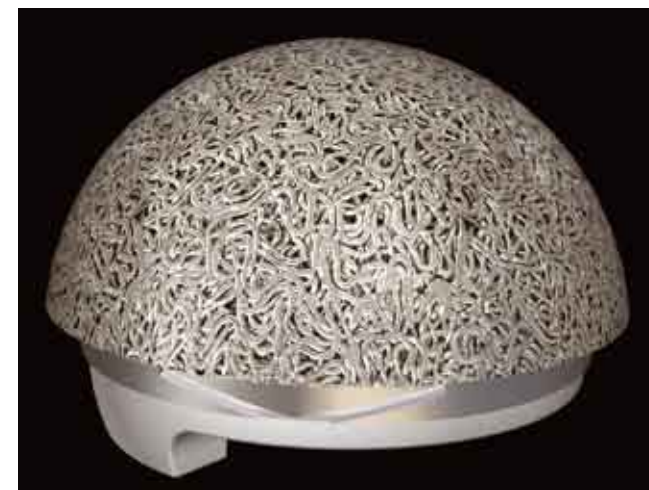
El liner se sujeta al shell mediante un sistema de clips de presión. Los extremos de tres pares de clips del borde del Shell se introducen en una ranura del liner. Los clips tienen una interferencia radial con la base de la ranura del liner que permite una firme sujeción.
